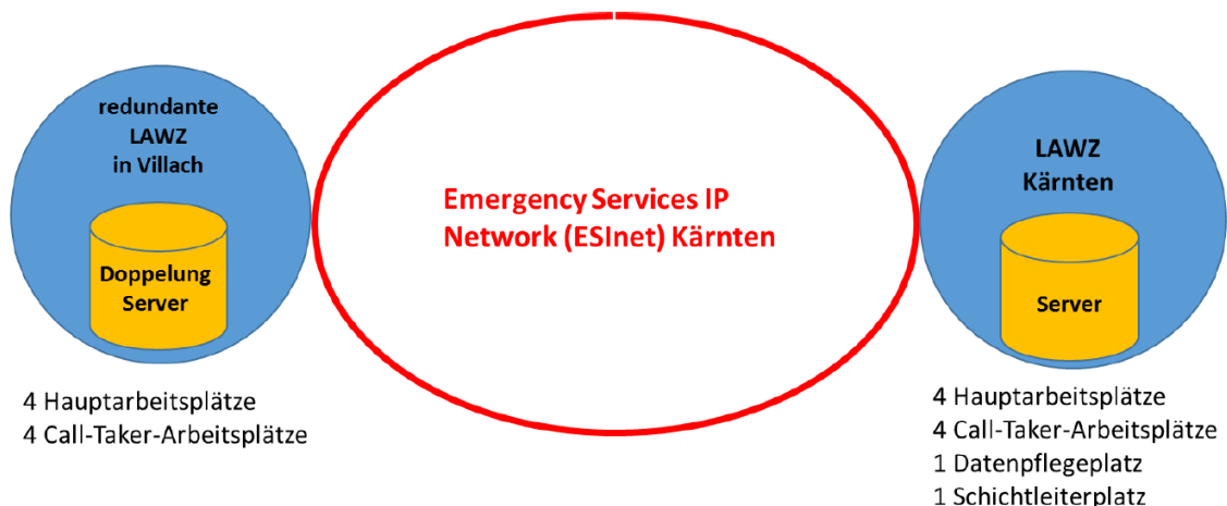
Abbildung 2: Variante 2 – LAWZ-Basis mit einer zentralen Redundanz in Villach
